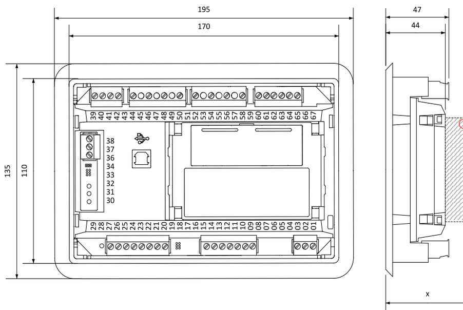
**Nota:** La profundidad final del controlador depende del módulo de extensión instalado – puede variar entre 41 mm y 56 mm. Tomar en consideración el tamaño de los conectores y cables (P.ej. En caso de conectores RS232, añadir unos 60 mm para conectores y cables standard).
